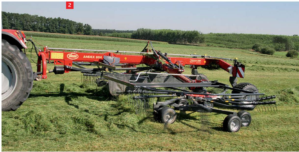
**1** Dank der großen Standardbereifung (380/55-17) ist der Andex in der Wiese bodenschonend unterwegs. Auf der Straße ist das Fahrverhalten unauffällig. Die Lenkung sorgt für guten Nachlauf.
