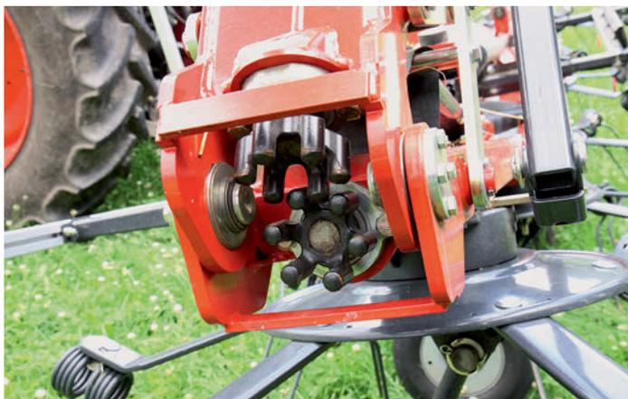
**Fanex 804/904:** An den äußeren Kreiseln haben an beiden Modellen Fingerkupplungen die früheren Weitwinkelgelenke abgelöst.
