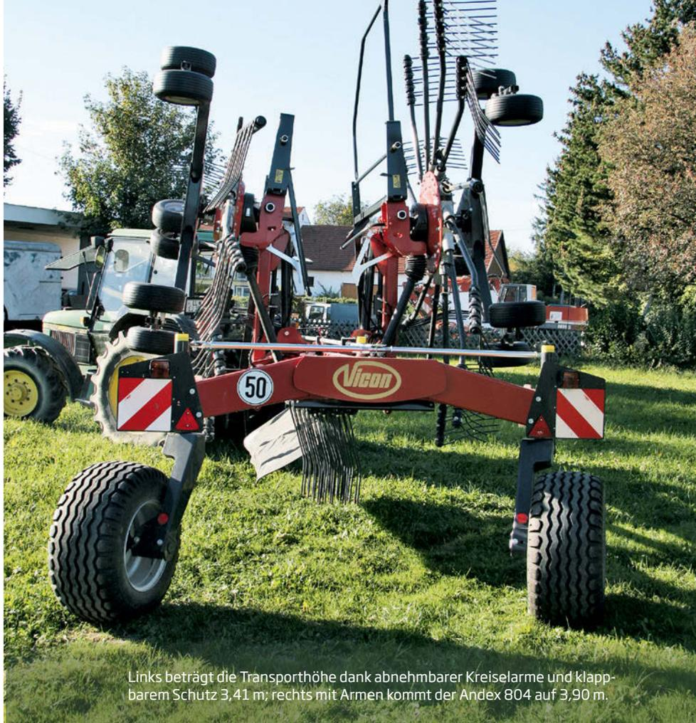
Links beträgt die Transporthöhe dank abnehmbarer Kreiselarme und klappbarem Schutz 3,41 m; rechts mit Armen kommt der Andex 804 auf 3,90 m.
