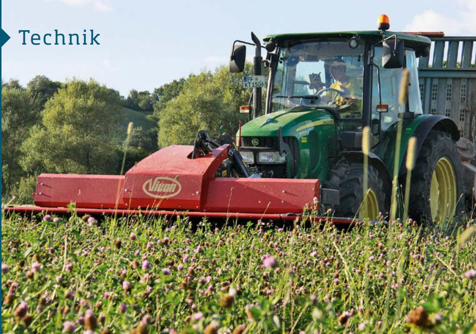
Um Grünfutter zu mähen und direkt aufzuladen, ist das XF bestens geeignet: Die Pick-Up nimmt ein kompaktes Schwad auf, das nicht überfahren wurde, und der Fahrer kann engere Kurven mähen.
