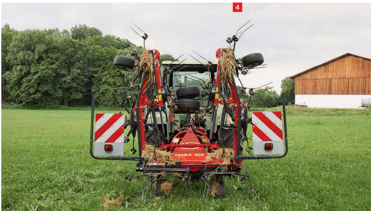
**1 Fanex 904:** Durch die Versteifung muss die Dreipunkthydraulik am Vorgehende weniger hoch gehoben werden, um alle Kreisel auszuheben.
