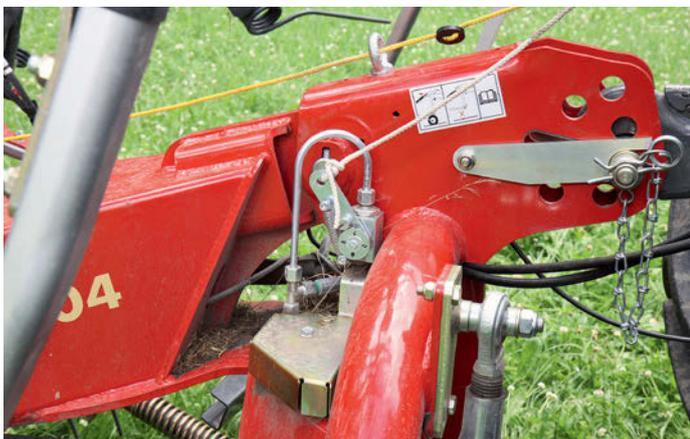
Fanex 804 und 904: Beide Testmaschinen waren mit dem Vorgewendeset ausgestattet, das per Seilzug ein- und ausgeschaltet wird.
