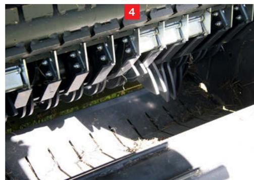
**1** Die federnd aufgehängte Pick-up mit gesteuerten Zinken nimmt das Erntegut sauber auf und erlaubt hohe Fahrgeschwindigkeiten.
