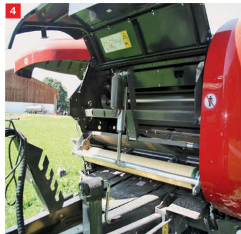
**1** Die Spiralen auf der Welle ziehen das Netz schön über die gesamte Ballenbreite beziehungsweise leicht darüber.
