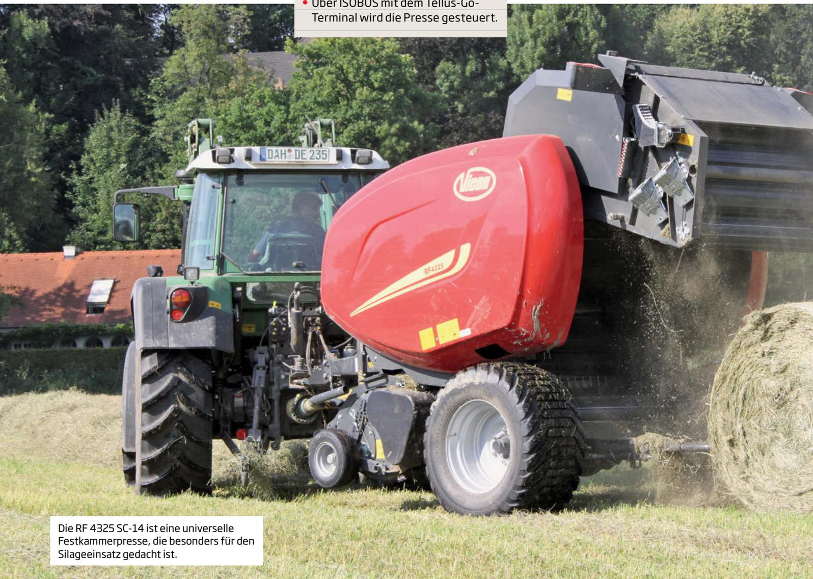
Die RF 4325 SC-14 ist eine universelle Festkammerpresse, die besonders für den Silageeinsatz gedacht ist.
