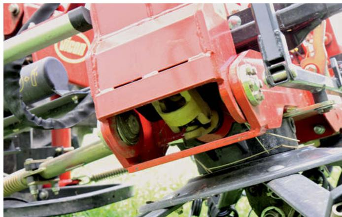
**Fanex 804/904:** Die übrigen Kreisel werden zur direkten Kraftübertragung von wartungsfreien Doppelkreuzgelenken angetrieben.
