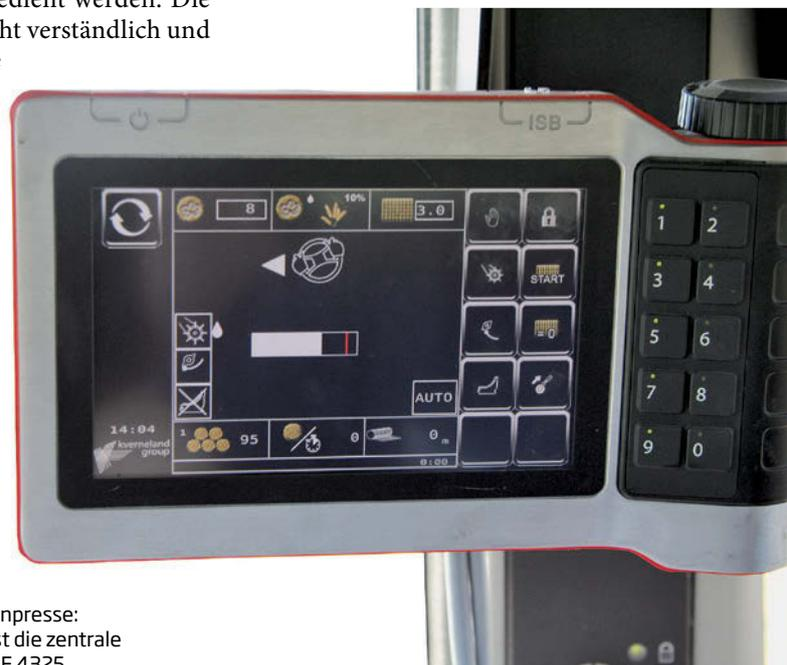
ISOBUS für die Rundballenpresse: Das Tellus-Go-Terminal ist die zentrale Bedienschnittstelle zur RF 4325.
